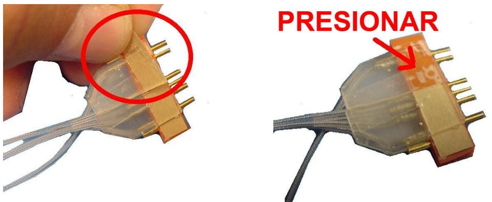
6. Quite la lámina adhesiva del lado derecho y presione la cubierta con firmeza contra el conector, como se muestra.
