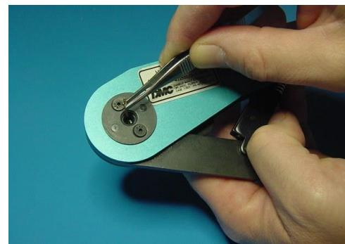
3. À l'aide de pinces, introduisez doucement l'extrémité en argent de l'électrode dans la plus large extrémité de la pointe en or placée dans l'outil de sertissage.
