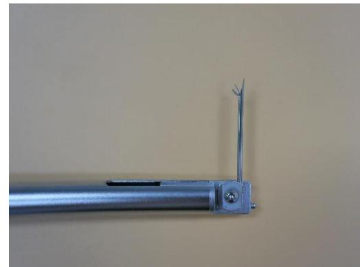
9. Vergewissern Sie sich, dass nur die Elektroden-Stimulationsspitze der Elektrode aus der Nadelspitze des Einweg-Elektroden-Einführinstruments austritt.
